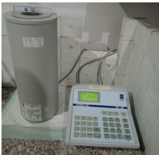
Gambar 1. Dose calibrator dengan Pelindung Ruang Ionisasi dengan Dipper di Bagian Atas, serta Pembacaan Elektronik (dokumentasi pribadi)
